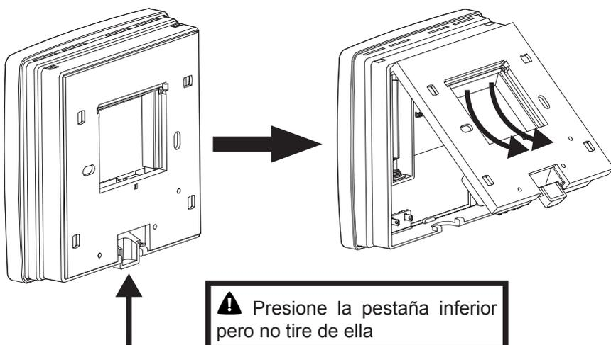
Atornille la base de pared a la pared y conecte los cables de la caldera a las bornas **COM** y **NO** (son las conexiones más habituales en calderas). El orden en que conecte ambos cables es indiferente.
