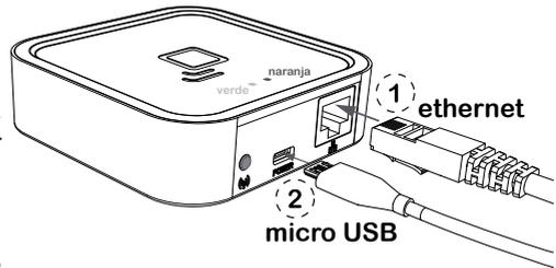
Espere dos minutos y compruebe mediante las luces LED de la centralita que está comunicándose correctamente con el router.
