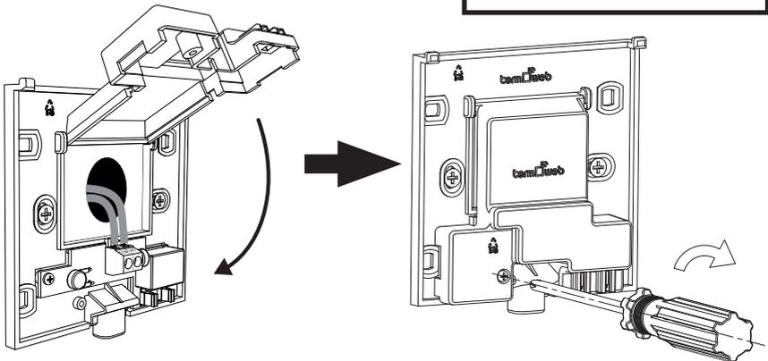
Coloque las pilas sobre el cronotermostato y móntelo sobre la base pared.
