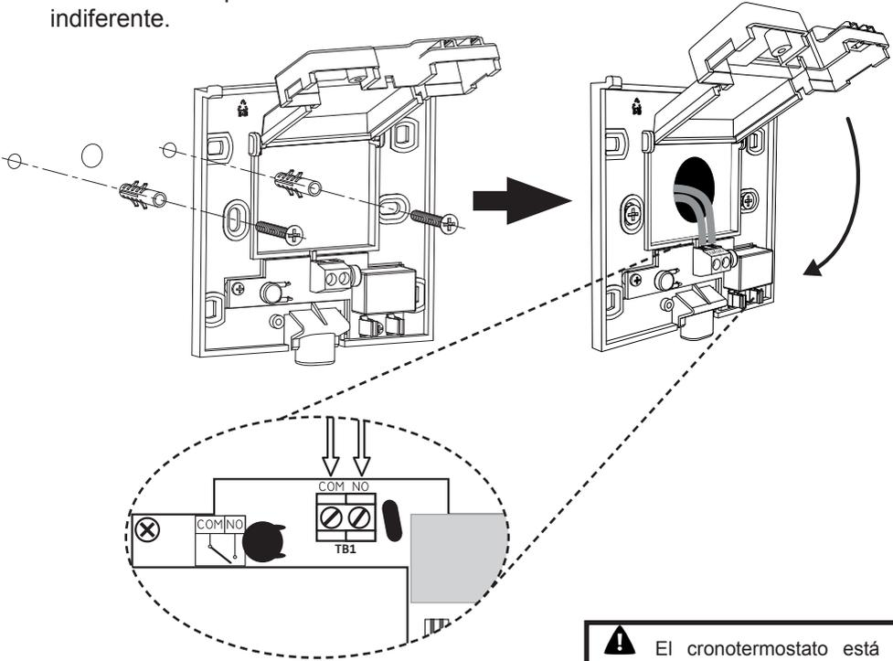
Una vez realizado el conexionado de los cables cierre la tapa y atorníllela.
