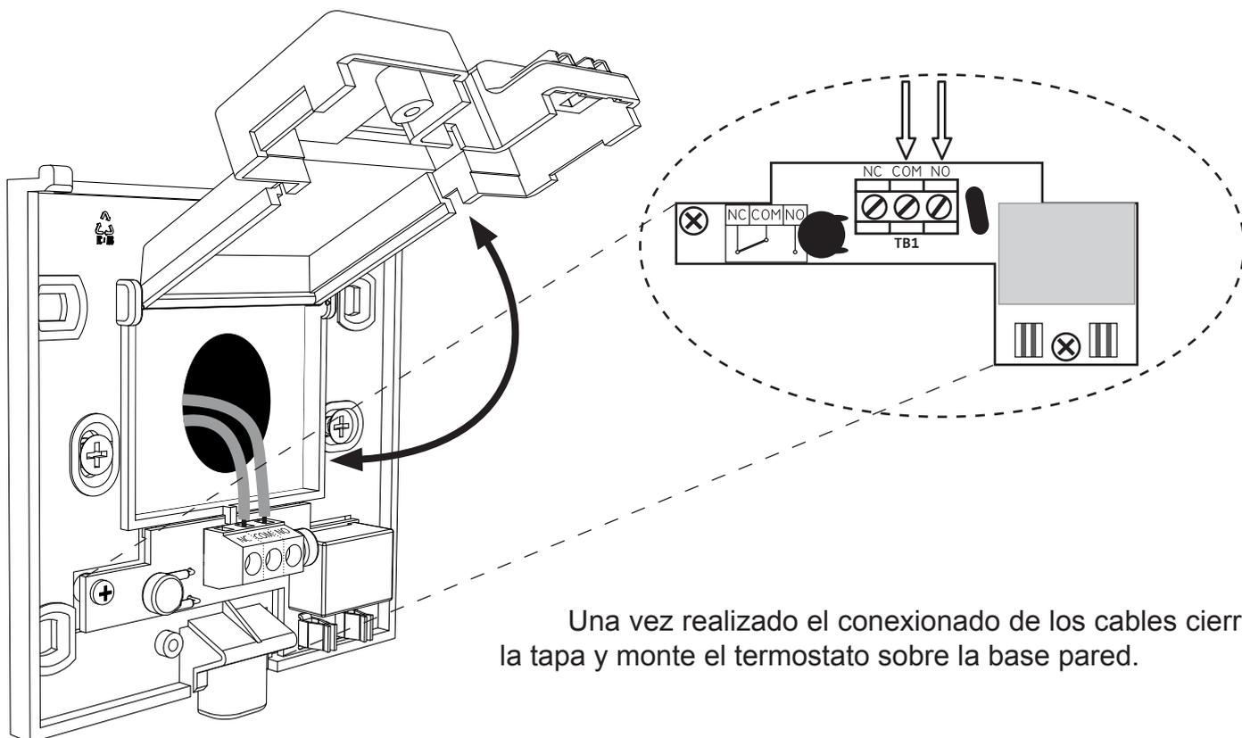
Una vez realizado el conexionado de los cables cierre la tapa y monte el termostato sobre la base pared.
