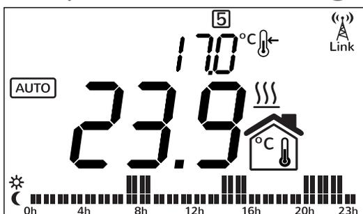
Se muestra la temperatura ambiente y se muestra alternada la hora/temperatura de consigna
