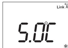
Presionando OK, cambiaremos las pantallas de las diferentes las temperaturas de consigna: Comfort, Eco y Antihielo, utilizar los botones +/- para cambiar el valor y el botón CONFIG para confirmar y salir.
