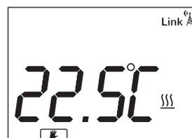
Dentro del modo Auto se puede subir o bajar la temperatura con las teclas +/-, el cambio se mantendrá hasta el próximo cambio en la programación o el cambio de día.
