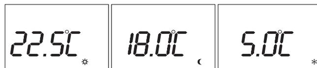
Presionando OK, cambiaremos las pantallas de las diferentes las temperaturas de consigna: Comfort, Eco y Antihielo, utilizar los botones +/- para cambiar el valor y el botón CONFIG para confirmar y salir.
