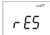
Para confirmar el RESET, presionar de nuevo **OK**, para cancelar el RESET presionar cualquier otra tecla.
